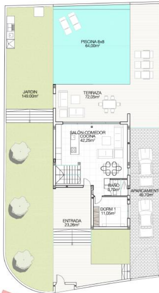
PLANTA BAJA Sup. construida 78.71 m 2
