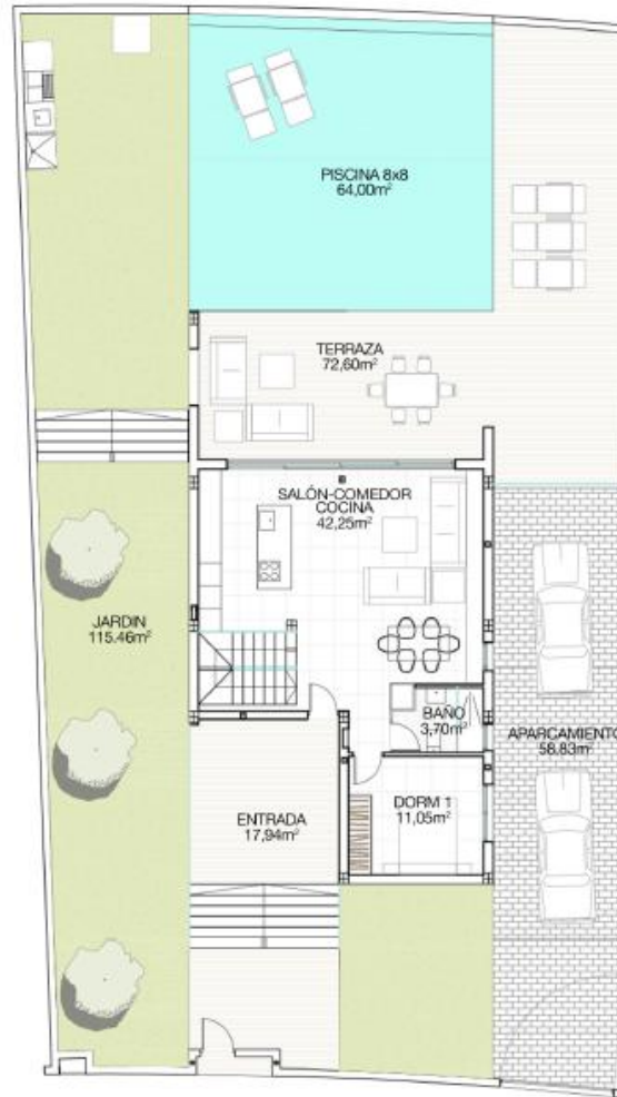
PLANTA BAJA Sup. construida 78.71 m 2
