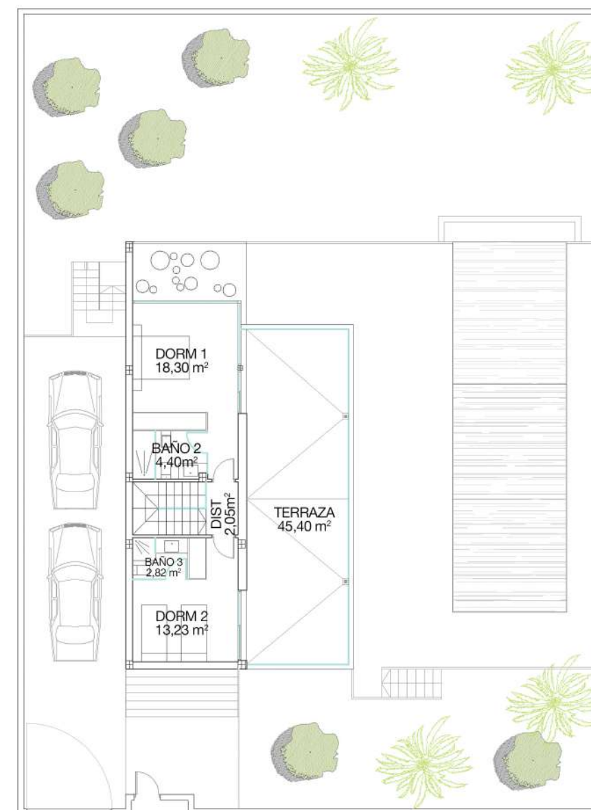
PLANTA ALTA Sup. construida 55,03 m 2
